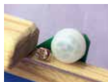
感度調整 人感&光それぞれボリュームで感度調整ができる。
