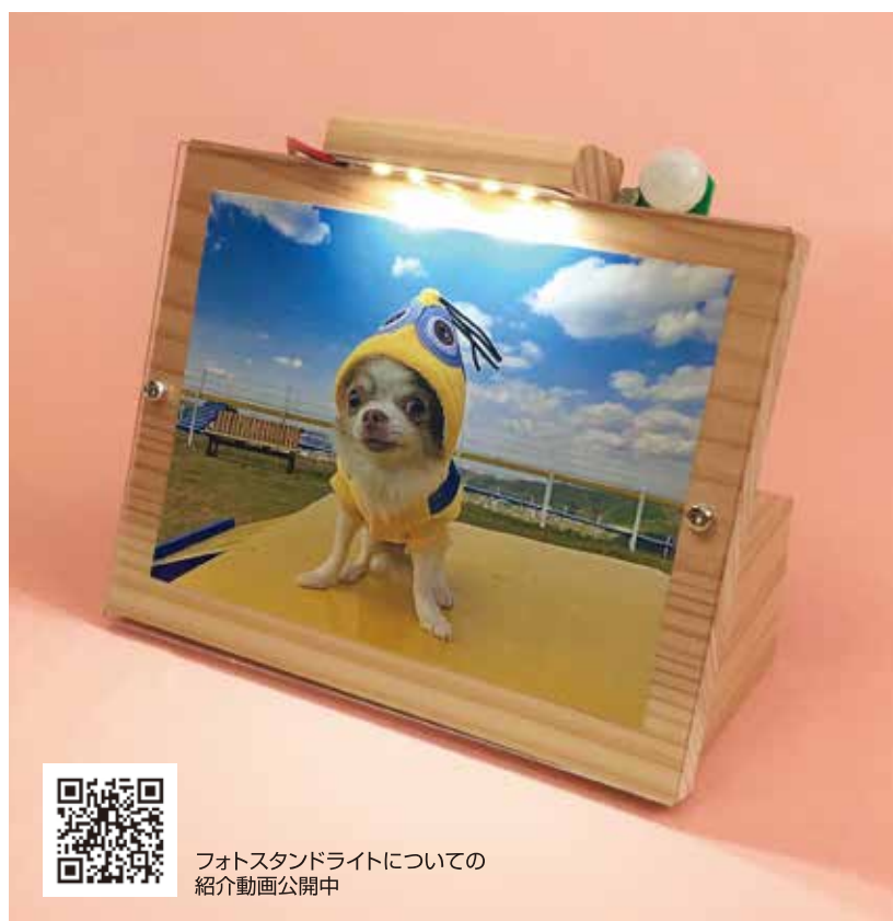
センサ 人感&光センサで暗いかつ人が 近づいた時反応
