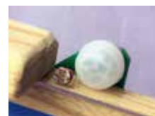
センサ 人感&光センサで暗いかつ人が 近づいた時反応
