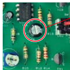
センサ 人感&光センサで暗いかつ人が 近づいた時反応
